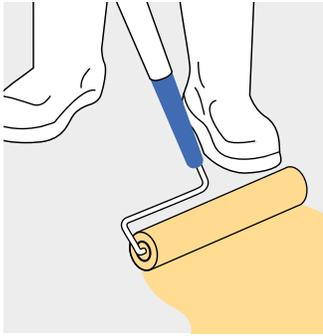
1. Teniendo el área limpia se **esparza de manera uniforme el pegamento de contacto en el área que se va a instalar**, también esparza el pegamento de manera uniforme en el material a instalar.
