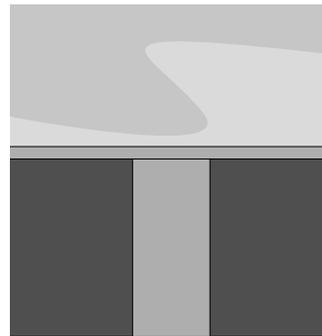
**2.** Se requiere que la superficie a instalar sea un firme de concreto nivelado y pulido, sin daño e imperfecciones.
