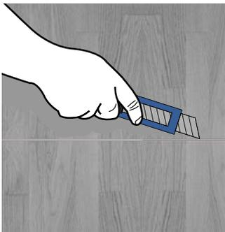
6. Por último, **se deben de rematar todas las uniones del piso** con el muro cortando el material con cúter.
