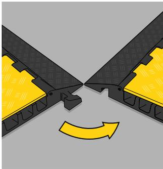
**3. Una los protectores de cable en cada extremo** hasta que abarque todo el ancho del paso vial.
