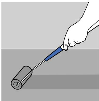
**3. Aplique pegamento de contacto sobre el respaldo del piso de PVC.**
