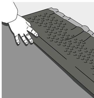
**4. Doble y volteé el piso uniformemente para iniciar colocación.**
