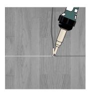
**9.** Comenzar a colocarla sobre las juntas del piso ya instalado.
