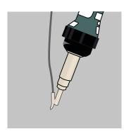
**8.** Colocar la punta del rollo en el orificio de la pistola de termofusión.
