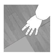
5. Comience a hacer el pegado del material del lado acolchado, cuidando las uniones que tengas una separación máximo de 3 mm.
