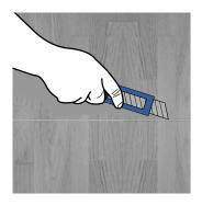
6. Por último, se deben de rematar todas las uniones del piso con el muro cortando el material con cúter.
